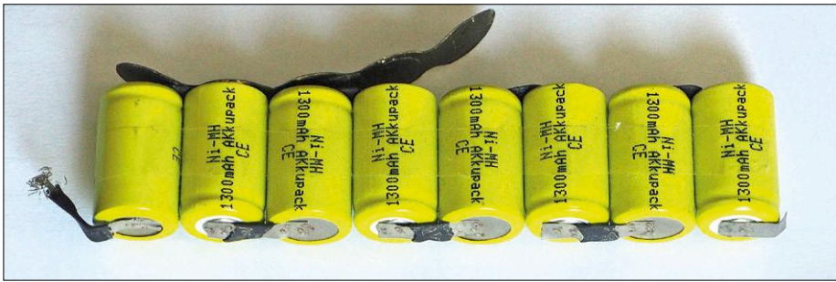
Figuur 3. Defect NiMh-accupakket van een kruimeldief. De gepuntlaste cellen leverden ooit 9,6 V bij 1,3 Ah.
